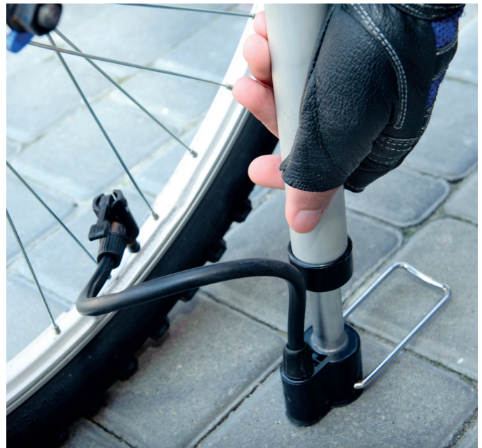
Fig. 2: Een fietspomp wordt warm door het samendrukken van lucht.
