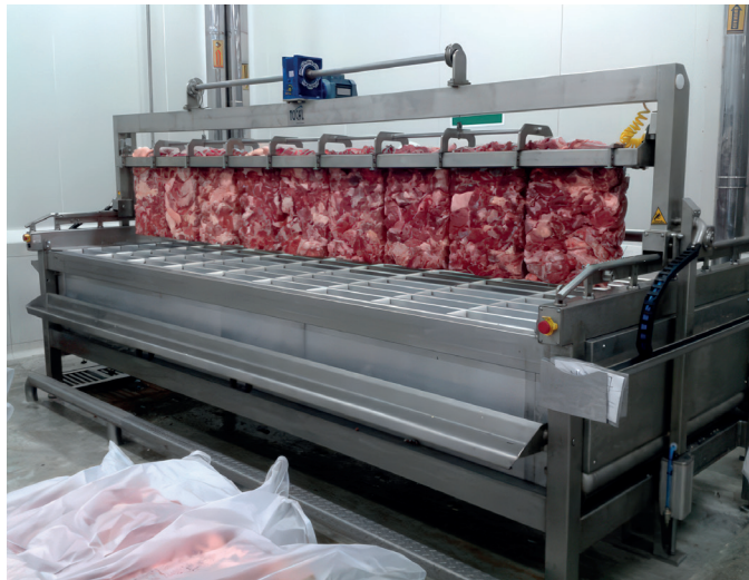
Fig. 1: Een plaatvriezer vraagt om een specifieke methode van ontdooien.
