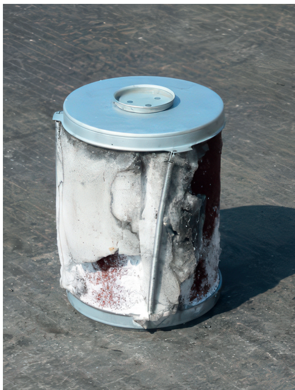
Fig. 1: Een extreem voorbeeld van een verzadigde filter/droger.
