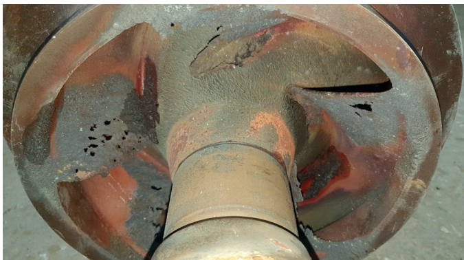
Fig. 2: Cavitieschade aan een pompwaaier.
