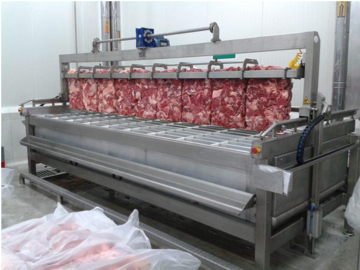
Afbeelding 1: Een plaatvriezer vraagt om een specifieke methode van ontdooien.
