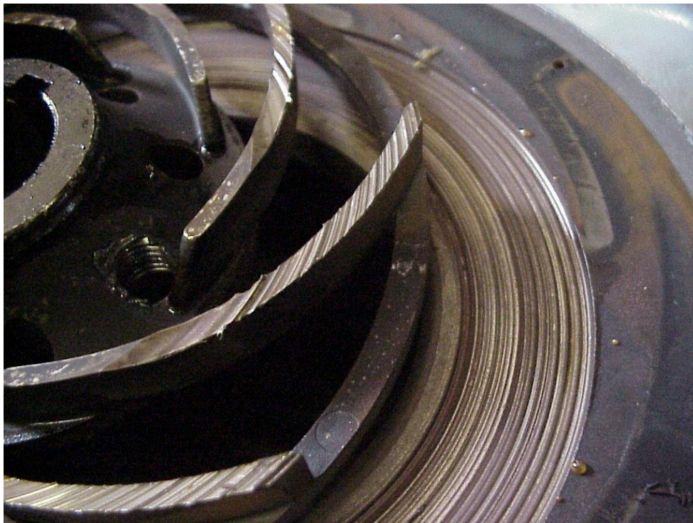
Figuur 3: Pomp met schade door ijs
