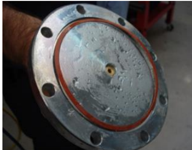
Figuur 2. Condens op koude componenten (foto: Emerson)
