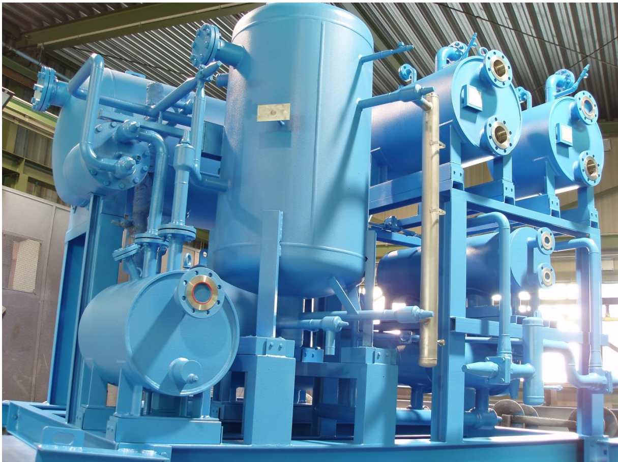
Een industriële warmtepomp met verschillende temperaturniveaus
