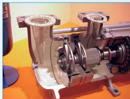
Foto 3: open gewerkt model van de WITT gesloten pomp, type HRP
