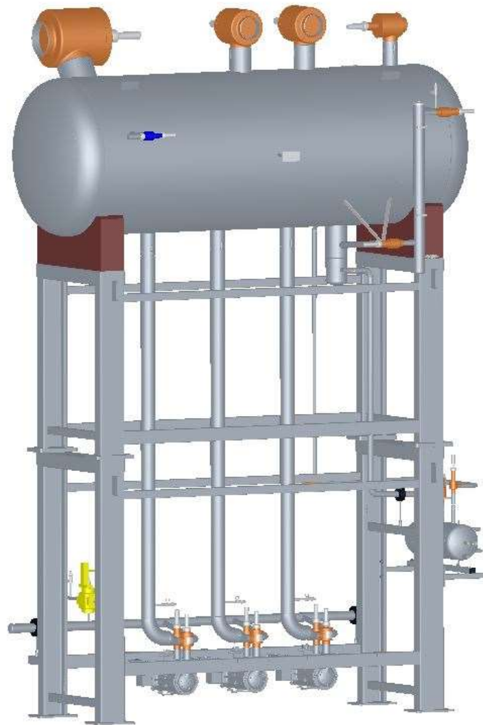
Fig. 4 Afscheider -35 °C NH 3 , om bouwtechnische reden is deze zeer hoog geplaatst.
