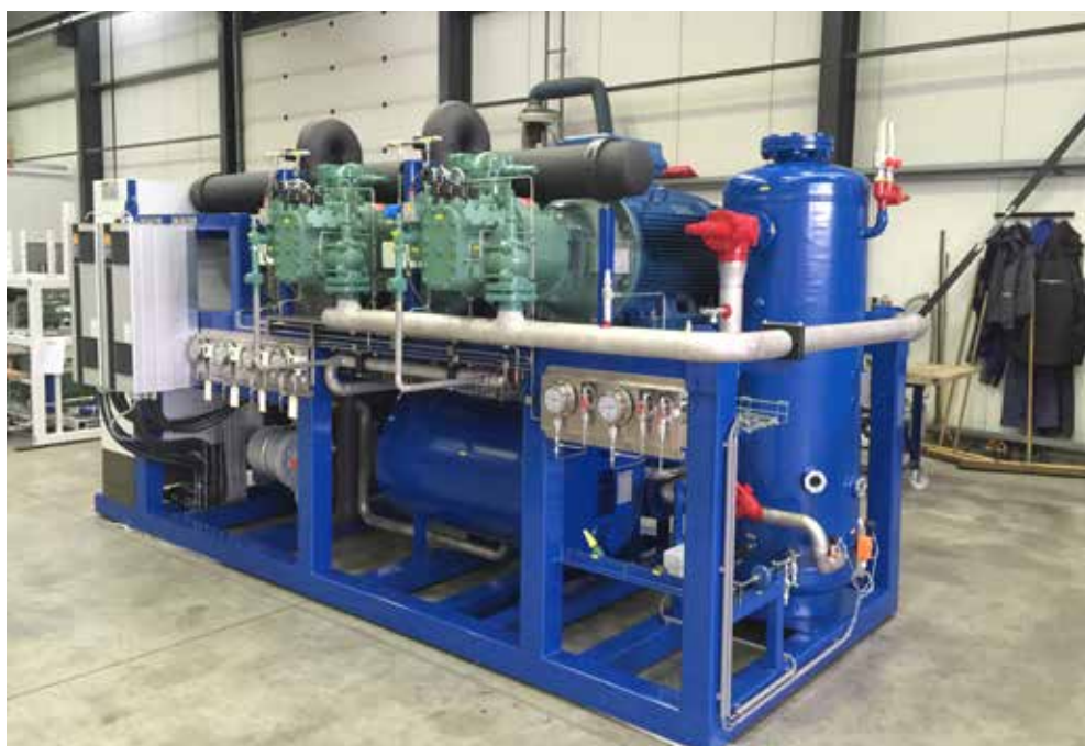
Een Wijbenga Low Charge NH 3 systeem met iQ-plate Koelvermogen 800 kW (Propyleenglycol 0 naar -5°C bij verdampingstemperatuur -10°C), R717 vulling 97 kg.
